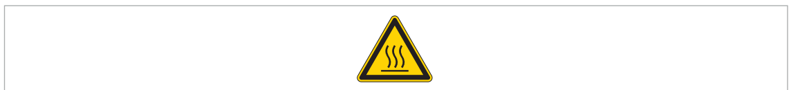
Fig. 1: Suitable warning sign acc. to DIN EN ISO 7010
